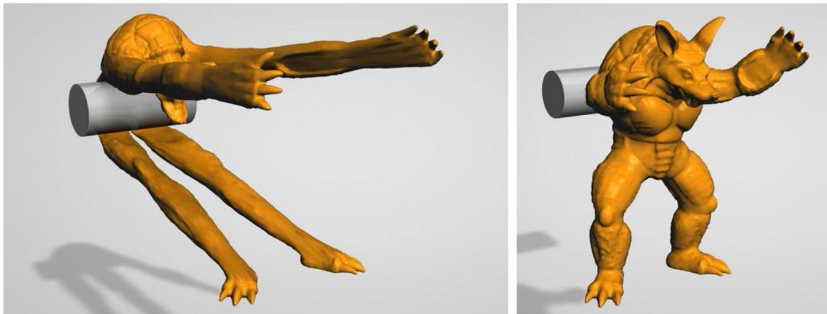
图 40 Shape Matching 方法模拟 Armadillo 产生的弹性形变效果
