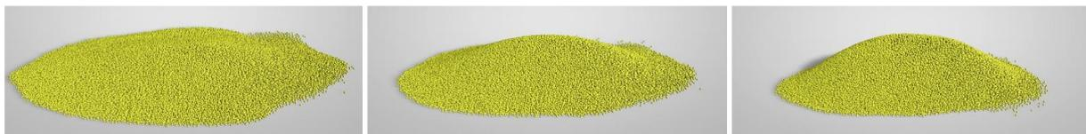
图 50 不同摩擦角参数下干沙堆的效果
